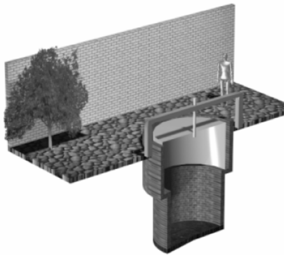
Figura 3 Representação tridimensional em corte do Biodigestor modelo Indiano.
